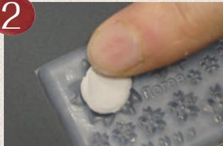
Drücken Sie 1.5g Art Clay Silber in die Mold. Es darf keine Luft zwischen Clay und Mold sein.
